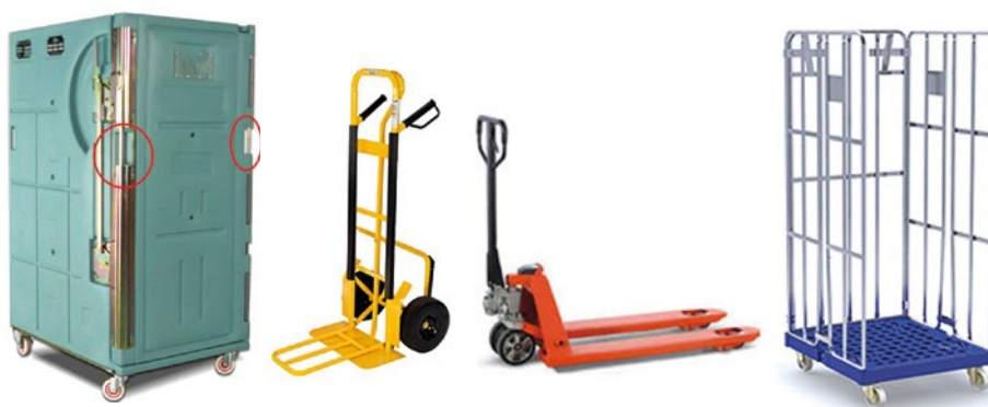
Abb. 18 Flurförderzeuge mit guter Griffgestaltung/Krafteinleitung.
